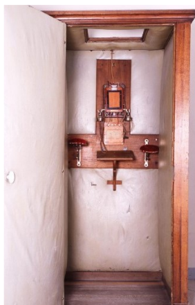
Une Cabine Téléphonique en bois, capitonnée, modèle 1900. Le téléphone intérieur est un modèle 1900 du fabricant D'Arsonval. À noter les accoudoirs de velours pour plus de confort et la tablette pour prendre des notes écrites... Photographies PTT. Coll. C. R-V.
